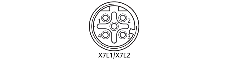
Fig. 4-3 Occupazione bin attacco bus di campo
