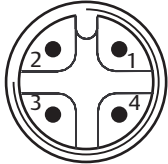
Fig. 12-6 Occupazione pin connettore M12
