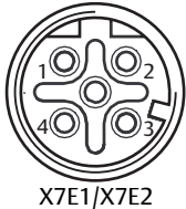
Fig. 4-3 Affectation des broches, raccordement bus de terrain
