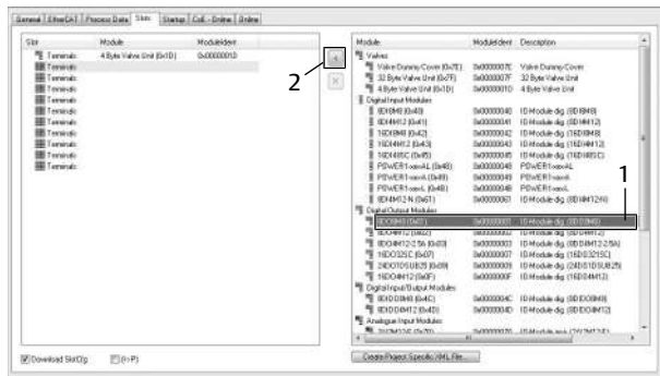
Fig. 5-6 Etape 2 : établissement de la liste de configuration
