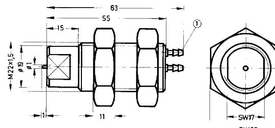
① Stecknippel für Kunststoffschlauch NW 3 Anschluß P schwarz, A gelb.
