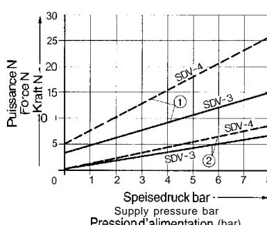
① Schließkraft = Kraft zum Aufbau von 90 % des Speisedrucks am Ausgang A.
