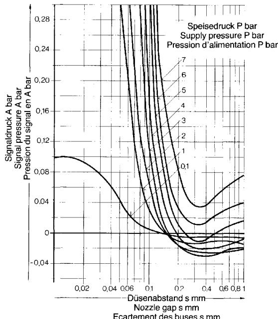
Exemple: Un écartement de 0,05 mm du détecteur de fin de course sous une pression d'alimentation de 4 bars, délivre un signal d'une pression de 2,5 bars (voir lignes en pointillés dans le tableau des diagrammes).
