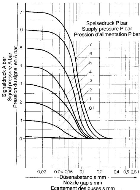
Beispiel: Ein Düsenabstand von 0,05 mm bei 4 bar Speisedruck ergibt einen Signaldruck von 2,5 bar (siehe gestrichelte Linie im Diagramm).
