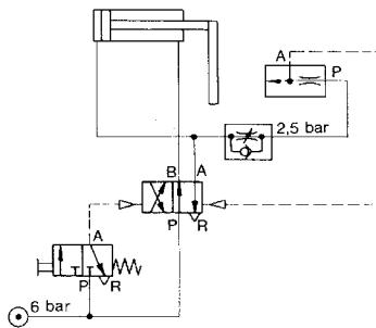
En supplément, nous recommandons d'alimenter seulement les détecteurs de fin de course en air comprimé lors de la délivrance d'un signal (voir exemples de schéma de montage).
